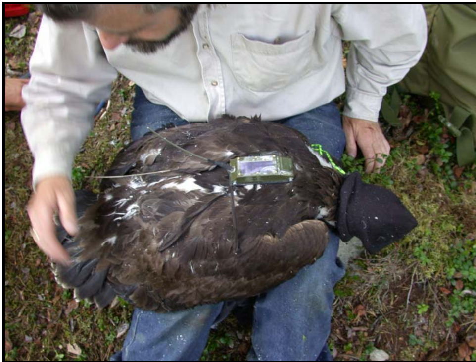
Figur 2. Satellittsender med solcellepanel med innebygd GPS-mottaker påmontert reirunge av kongeørn. - Satellite transmitter with built-in GPS receiver powered by a solar panel mounted on a juvenile golden eagle. Foto ©: Geir Systad, NINA
