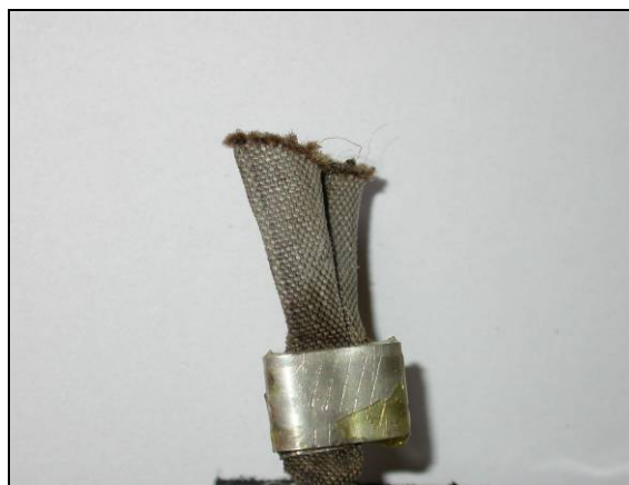
Figur 16. Nærbilde av festebåndet på sender nr 52456, funnet øst for Torneträsk. Det rene kuttet ser ut til å ha vært utført med en skarp gjenstand. – Close-up of harness from the 52456 bird, found east of Torneträsk. It seems as if the teflon ribbon has been cut by a sharp object
